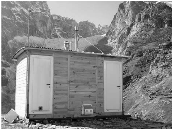
Figura 1: La stazione climatica ABC-Pyramid, installata nel febbraio 2006 a 5079 m sul versante meridionale della catena himalayana.
