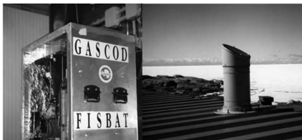
Figura 1: Spettrometro GASCOD installato alla Stazione "M.Zucchelli" dal 1995.
