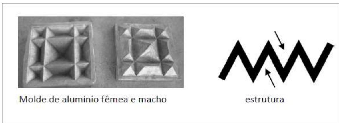
Figura 3 - molde de alumínio para compressão das aparas. Fonte: elaborado pelo autor
